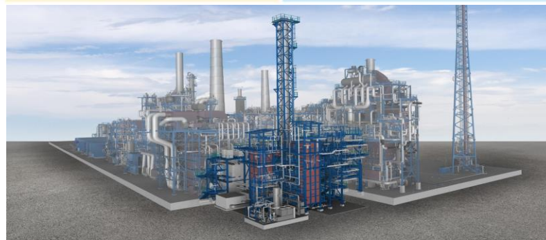
رسم ثلاثي الأبعاد لثول مصنع تجريبي في العالم لافران التكسير البخاري المسخنة كهربائياً على نطاق واسع في لودفيشهافن
